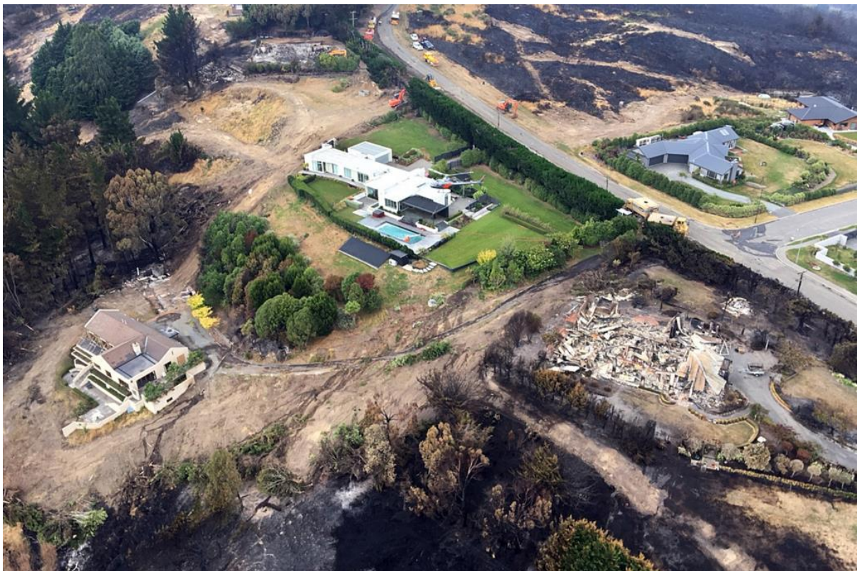
Abbildung 5: Unterschied zwischen vorbereiteten Gebäuden mit Abstand zu brennbarer Vegetation (Links und Mitte) und unvorbereitetem Gebäude, welches an brennbare Vegetation grenzt (Rechts)
