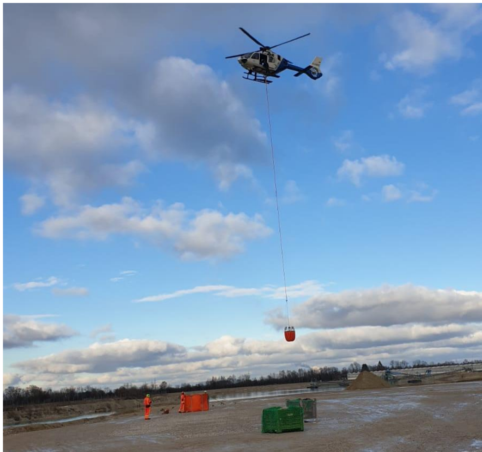
Abb. 2.7.2.3/3: Long-Line an Bambi-Bucket bei einer Übung zur Befüllung eines Behälters am Boden. (Foto: FF München)
