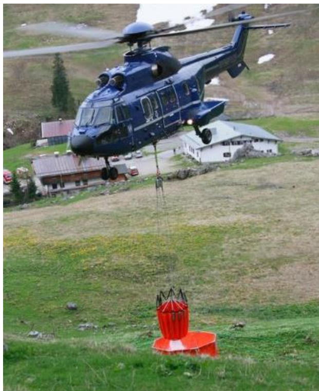
Abb. 2.7.2.3/2: „Belly-Hook“ am Bambi-Bucket. (Foto: FF München)
