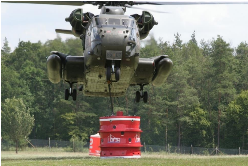
Abb. 2.7.2.3/1: „Belly-Hook“ am Smokey. (Foto: Feuerweherschule Würzburg)
