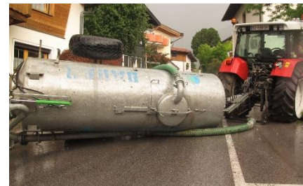
Unfallgefahr - insbesondere nicht vollgefüllte Tankwagen neigen zu schwammigem Fahrverhalten; Freiwillige Feuerwehr Schwaz, 03.05.2017
