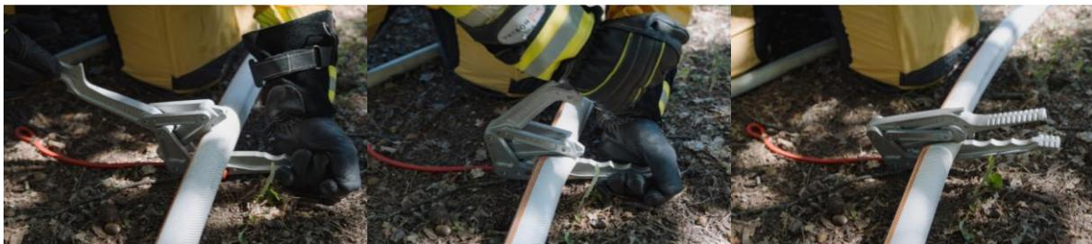
Abbildung 1: Anwendung einer Schlauchklemme. Durch die selbstsichernde Konstruktion bleibt die Klemme geschlossen, so dass eine Einsatzkraft die Schlauchleitung selbst verlängern kann.
